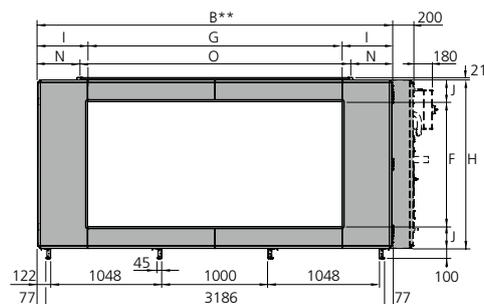
\* Se l'accessorio per canali è situato in un alloggiamento isolato, l'AHU è fornita senza pannello di connessione terminale; l'AHU può inoltre essere fornita con pannello di connessione terminale full face (accessorio).
