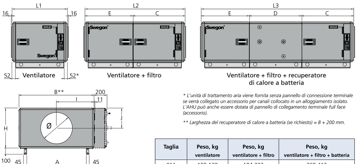
\* L'unità di trattamento aria viene fornita senza pannello di connessione terminale se verrà collegato un accessorio per canali collocato in un alloggiamento isolato. L'AHU può anche essere dotata di pannello di collegamento terminale full face (accessorio).
