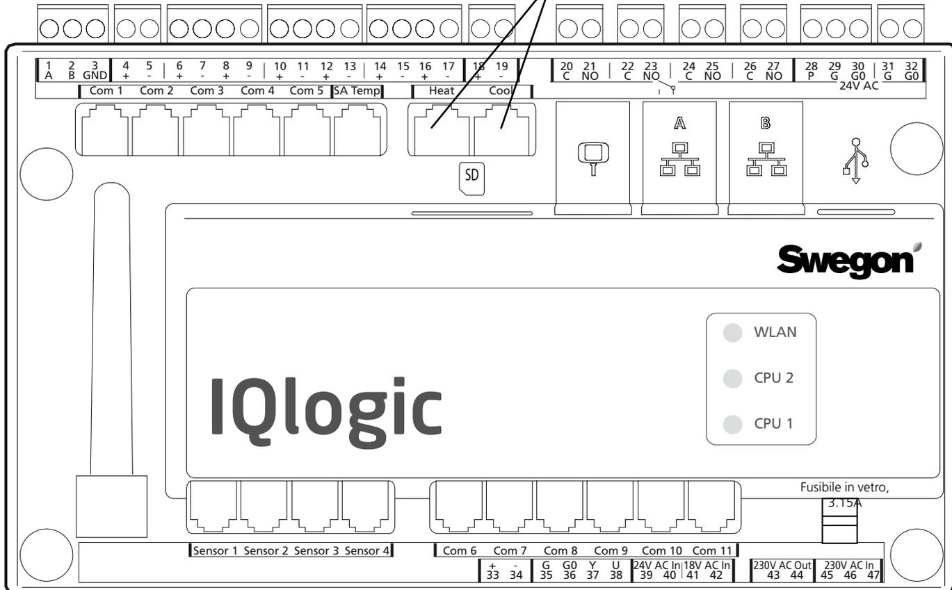
Gli ingressi digitali, morsetti 4-17, sono di tipo a bassissima tensione. Gli ingressi analogici, morsetti 18-19, hanno un'impedenza di ingresso di 66 k $\Omega$ . Tensione di controllo di 230 V CA sui morsetti esterni 101 (L) e 102 (N).
