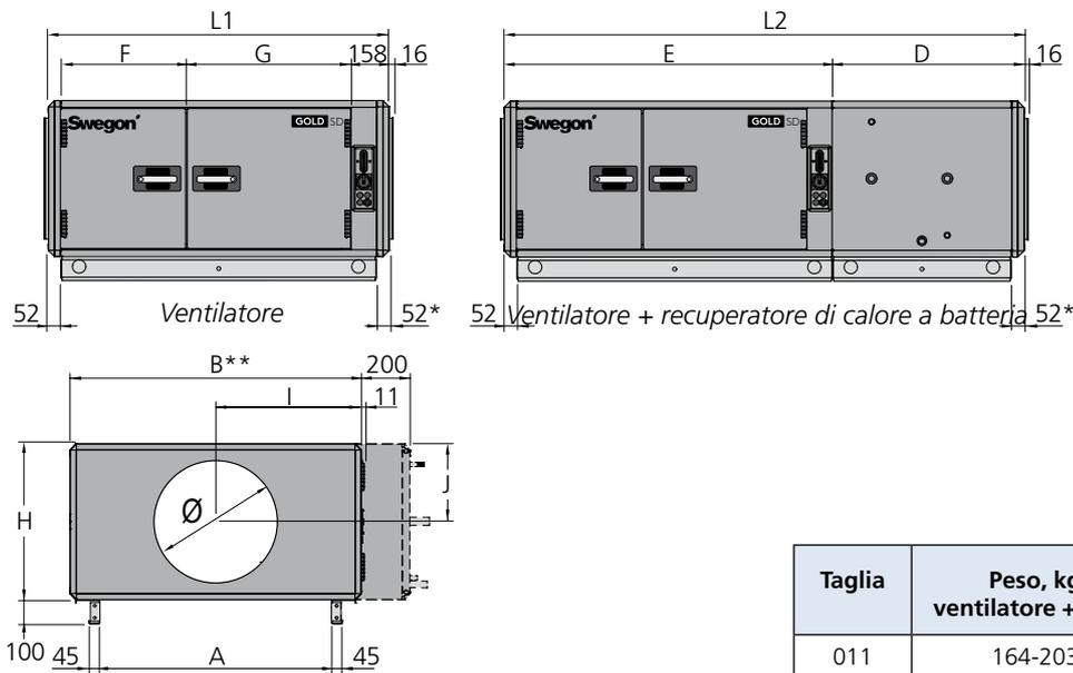
\* L'unità di trattamento aria viene fornita senza pannello di connessione terminale se verrà collegato un accessorio per canali collocato in un alloggiamento isolato. L'AHU può anche essere dotata di pannello di collegamento terminale full face (accessorio).
