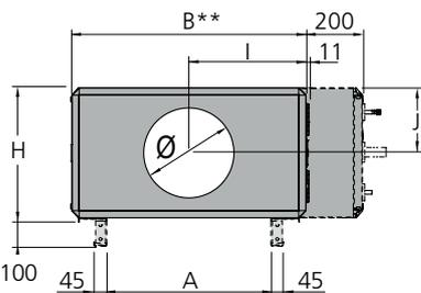
\* L'unità di trattamento aria viene fornita senza pannello di connessione terminale se verrà collegato un accessorio per canali collocato in un alloggiamento isolato. L'AHU può anche essere dotata di pannello di collegamento terminale full face (accessorio).
