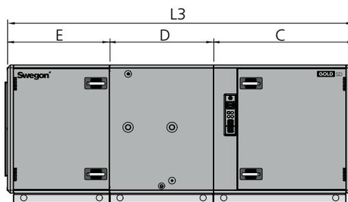
Ventilatore + filtro + rec. di calore a batteria
