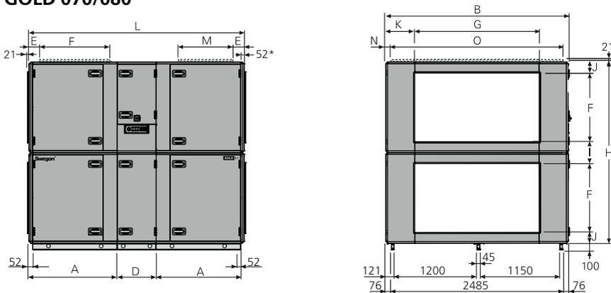
\* La CTA est fournie sans panneau d'extrémité lorsqu'un accessoire en caisson isolé est prévu. La CTA peut également être fournie avec panneau de raccordement à passage d'air intégral (en option).
