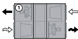
Tilluft oppe (venstreinspeksjon)
