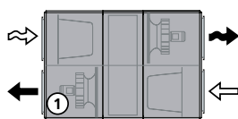
Tilluft nede (venstreposisjon). Ikke RX størrelse 004-008 i felles kabinett.
