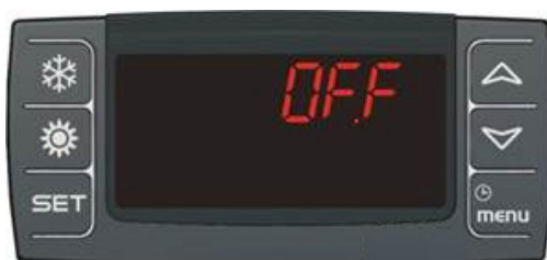
Fig. 8 Visa parameterkontroll med öppen extern klarsignal
