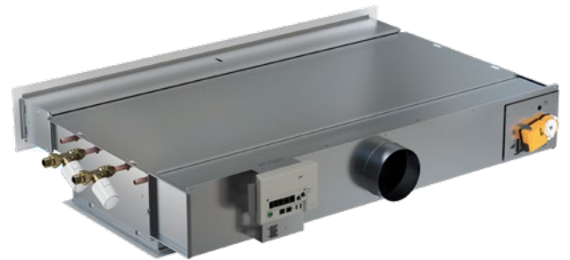
Kuva 12. WISE Paragon, jossa vesiliitäntä vasemmalla puolella. Täydellinen tuote, jossa on tehtaalla asennettu WISE CU -ohjausyksikkö, toimilaitteet sekä venttiilit ja venttiilitoimilaitteet jäähdytys- ja lämmitysvettä varten.
