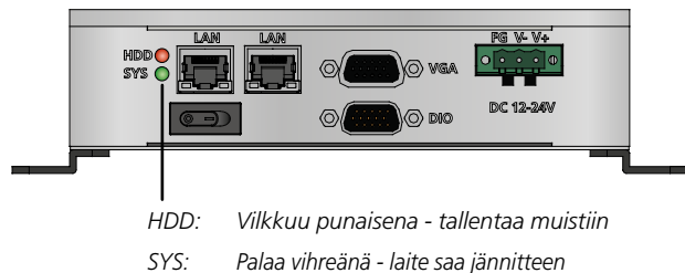
Kuva 12. SuperWISE II -ohjausyksikön merkkivalojen selitykset.
